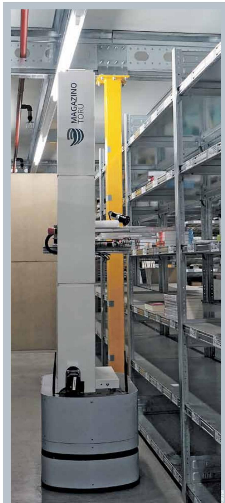
**Künstlicher Kollege:** Der Roboter Toru Cube der Startup-Firma Magazino arbeitet selbstständig im Lager und kommissioniert zum Beispiel Bücher.
